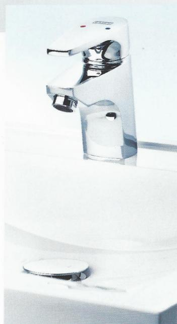
◀ Der „Aquafit“-Einhebelmischer AQFT0017 DN 15 mit Mischkartusche mit keramischen Scheiben und thermostatischem Verbrühungsschutz lt. DIN EN 111, festeingestellt auf maximal 38°C, ist als Standbatterie für barrierefreie Waschanlagen ausgeführt. Ab ca. 198 €. (Foto: Franke Aquarotter)
